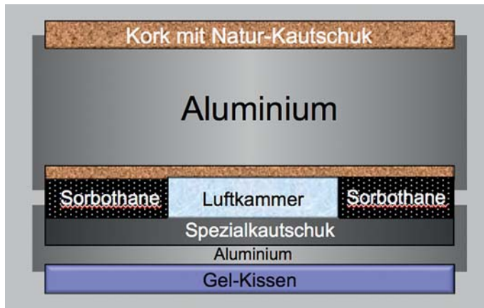
Aufbau der »Pure«-Dämpfungselemente
